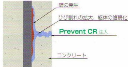
「Prevent CR」は低粘度なため注入が容易であり、クラック部、接合間隙部などに容易に浸透します。
